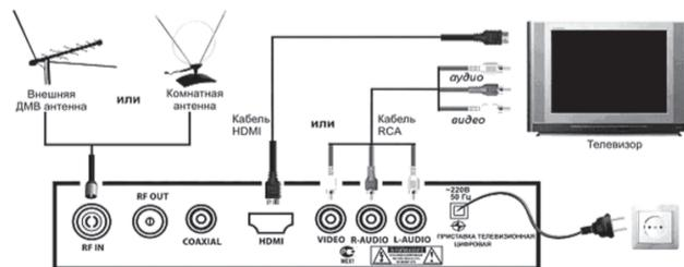
**Фото 5. Схема приема цифрового телевизионного сигнала**
